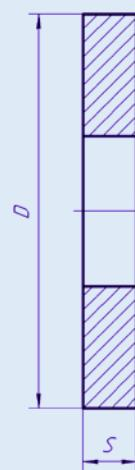
Предназначены для установки между фланцами при необходимости создания в трубопроводе подпора (противодавления), ограничения расхода и др.
